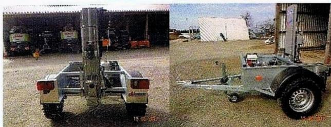
Das Bodenprobenentnahmeggerät N 2006 ist auf einem Autohänger (zul. Ges. Gew. 750 kg) montiert und arbeitet autonom vom Zugfahrzeug. Lediglich die Stromversorgung ist über die Beleuchtungssteckdose sicherzustellen (12 V 10 A).
